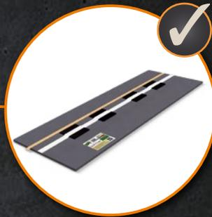
Die Trittschallplatte Typ NF dient zur schalltechnischen Entkoppelung von Treppenläufen bzw. Podesten mit Konsolbändern. Die Betonelemente können dabei in Ortbeton oder auch als Fertigteil ausgeführt werden. Eine Anpassung der Trittschallplatte an verschiedene geometrische Formen der Betonelemente ist bauseits problemlos mittels Schneiden möglich. Mit dem Sondertyp NF-VH können auch Horizontallasten aus planmäßigen Beanspruchungen übertragen werden.
