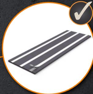
Die Trittschallplatte Typ NL dient der schallbrückenfreien Ausbildung der Fuge zwischen Treppen bzw. Podesten und den Treppenhäuswänden. Die Betonelemente können dabei in Ortbeton als auch als Fertigteil ausgeführt werden. Die Platten sind selbstklebend und bestehen aus PE-Schaumplatten, die keine tragende Wirkung haben. Eine Anpassung der Trittschallplatte an verschiedene Formen des Treppenlaufes ist bauseits problemlos mittels Schneiden möglich.
